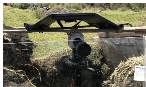
Phantom v2512 高速摄像机,离爆炸试验点 30 米远。
